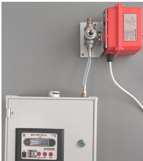
Рисунок 4.2 Вид БПС с краном перекрытия тракта подачи пробы
